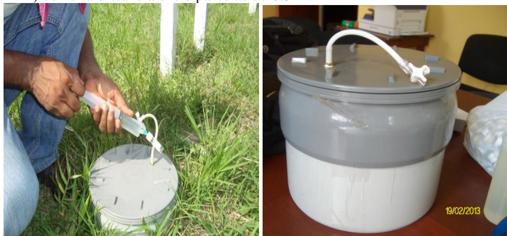
Figura 1. Cámara de PVC de flujo cerrado instalada en campo para medir N_2O .
